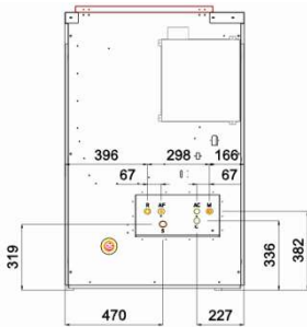
USCITA FUMI D. 100 mm Fumes outlet d. 100 mm
